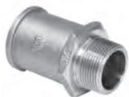
Rotguss – Innen Gewinde Parallel (ISO 228) - Außen Gewinde Konisch (ISO 7)
